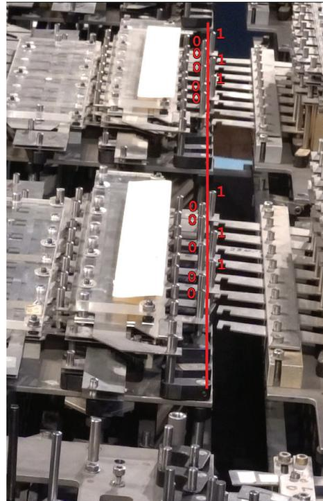
Zwei Bytes auf dem Datenbus der Z1. Die Logikpegel sind 0 und 7mm Die Bytes sind: 1001 0100 1001 0100
